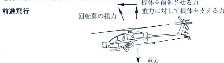
同様に、回転翼を左右に傾けることによって側進飛行したり、後ろに傾けて後進飛行することができます。前進速度が大きな場合は、左右に回転翼を傾けると、機体は飛行機のように旋回をします。これは、機体を横に引っ張る力と遠心力がつり合うからです。ヘリコプターが速度を上げると、翼回転面を通過する空気の流れは、揚力に影響を及ぼします。前方から後方に向けて回転している羽根は、空気の流れと同じ方向に動いていることになり、翼にあたる空気の速度は小さくなります。逆に、後方から前方に回転している羽根に当たる空気の速度は大きくなり、左右で発生する揚力の大きさに差ができることがあります。この影響を補正するために、回転翼は左右のピッチを自動的に調整するようになっています。
